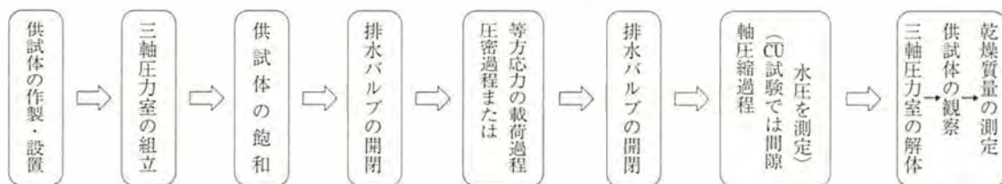
図-14.1 三軸圧縮試験における作業の流れ
