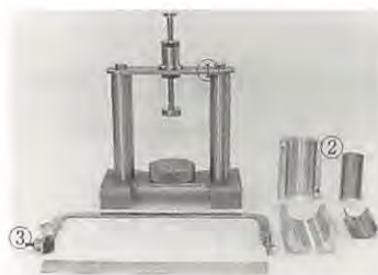
図-14.5 供試体作製器具 (トリミング法の場合)
