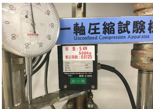
写真-10 容量 5kN のロードセルを使用
