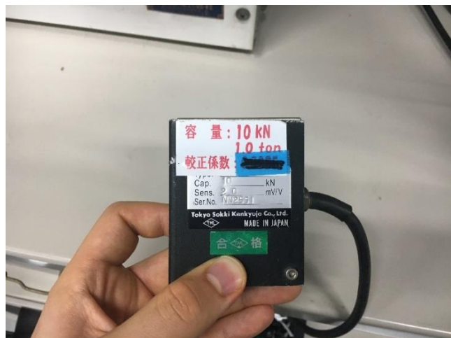
写真-11 容量 10kN のロードセル
