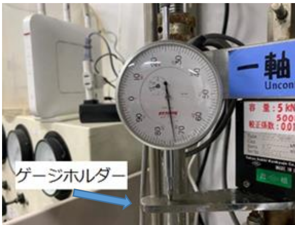
写真-16 変位計を垂直になるよう設置
