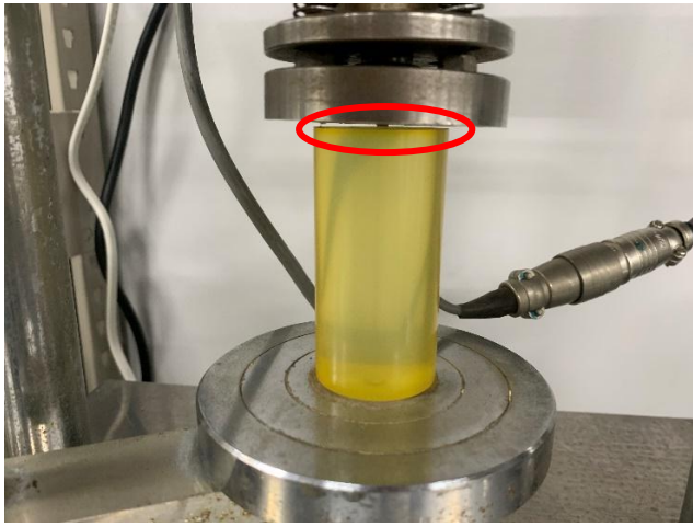
写真-15 加圧版上部 1mm まで近づける
