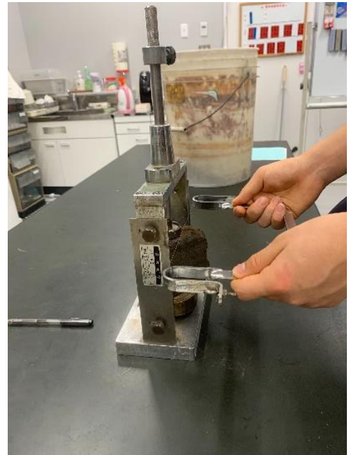
写真-7 ワイヤソーで土を削り落とす
