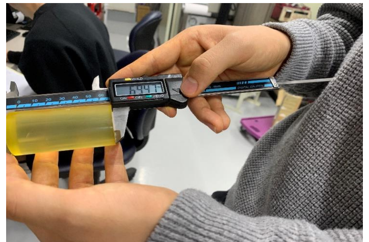
写真-8 ノギスで高さを測っている
